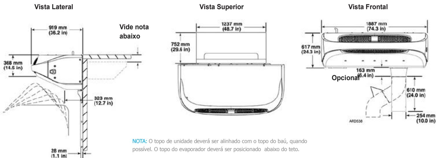
**NOTA:** O topo de unidade deverá ser alinhado com o topo do baú, quando possível. O topo do evaporador deverá ser posicionado abaixo do teto.
